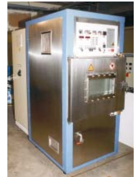
Diskontinuierliche Mikrowellenkammer mit Umluft
