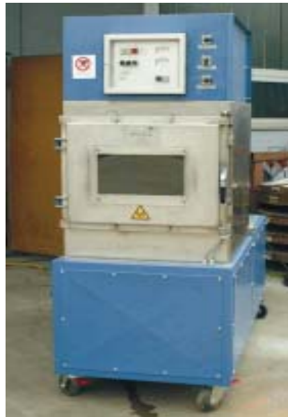
Mikrowellenkammer mit einer Leistung von 6 kW, stufenlos regelbar, mit Abluftsystem.
