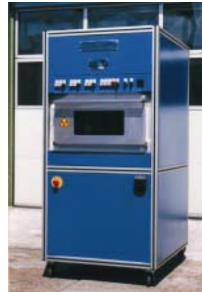
Mikrowellenkammer mit einer Leistung von dreimal 1,2 kW, schaltbar und stufenlos regelbar.
