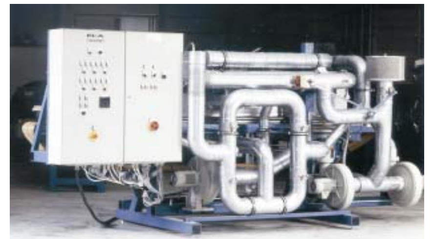
Kontinuierliche Mikrowellenhybridanlage (Mikrowelle/Kontakt)
