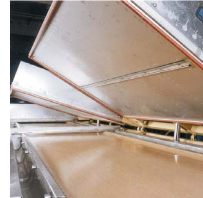
Kontaktbandrockner in Sonderbauform für besonders gute Reinigung
