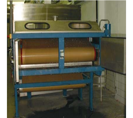
Auslaufteil mit Antriebswalze (oben) und Umlenkrollen (unten)
