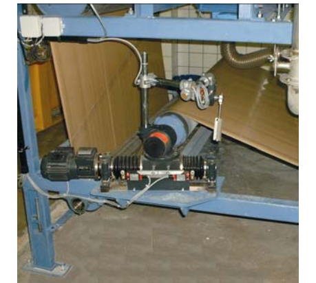
Steuerwalze zur automatischen Steuerung des Bandlaufes
