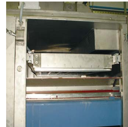
Innenansicht Trockenkammer mit zu Reinigungszwecken ausziehbarer Infrarotzusatzheizung
