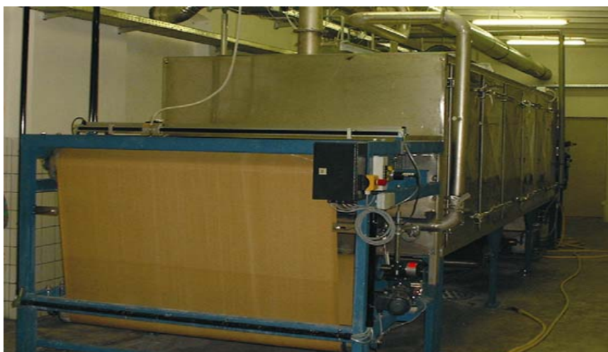
Kontaktbandrockner, oben: thermalölbeheizt; unten: elektroheizt
