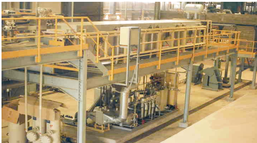
Kontaktbandrockner, oben: thermalölbeheizt; unten: elektroheizt
