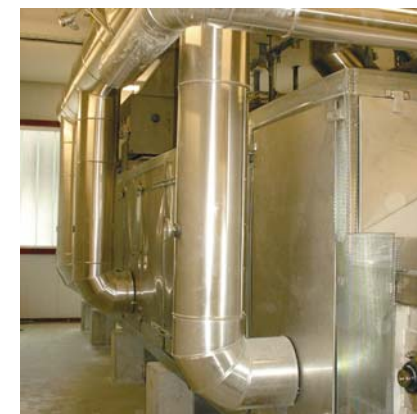
Bandtrockner mit Heißgasbeheizung in Edelstahl
