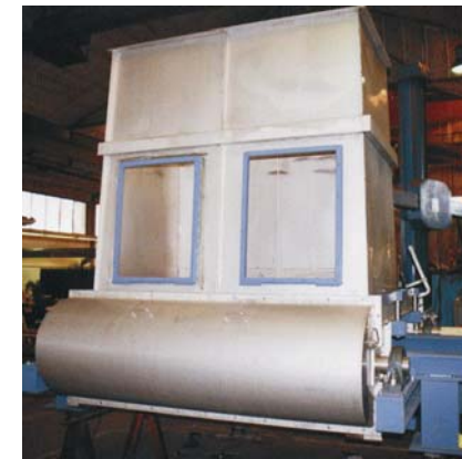
Kastenbeschicker mit Bandantrieb und stirnseitigen Wartungstüren
