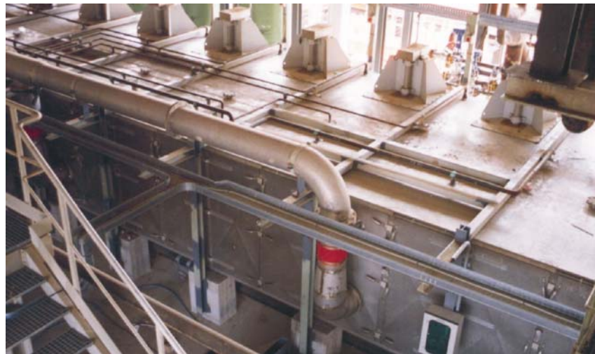
Konvektiver Bandtrockner in Modulbauweise (oben)
